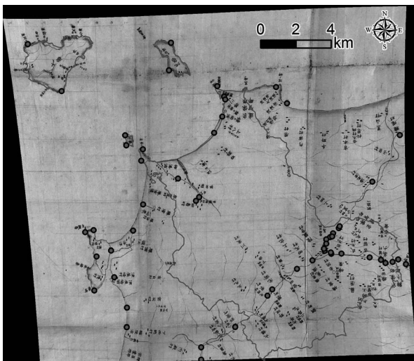
図1 伊能大図 No.186 の幾何補正結果 ○はGCPを示す。
