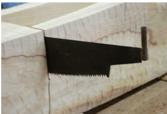
図15 2015/02/15 横挽大鋸による切断
