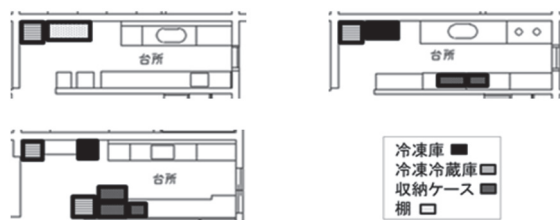
図4 g クラブ (左上), f クラブ (右上), h クラブ (左下) の台所平面図及び保管スペース
