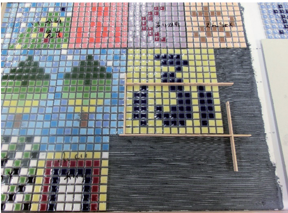
図3 パネルに接着剤を塗布しタイルを接着する様子
