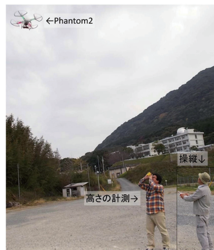
写真 5 GoPro3 搭載の UAV 試験
