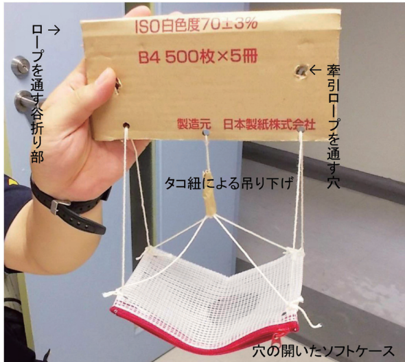
写真 1 カメラ吊り下げ部の工夫
