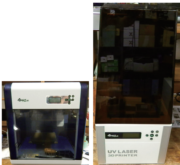
図1 左:熱溶解造形方式(FDM)(XYZ Printing社製, ダビンチ 1.0A), 右:光造形方式(SLA)(XYZ Printing社製, ノーベル 1.0)
