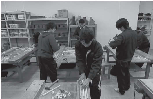
図 10 練習用の材料でかなばを確認しながら削る様子
