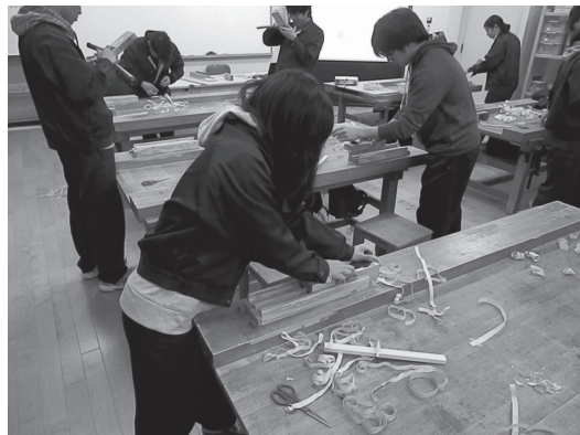
図 12 F型かなばの生成を目指して鉋削りを行っている様子
