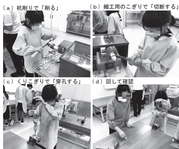
図2 小型木工ろくろを用いて手回し独楽を作っている様子
