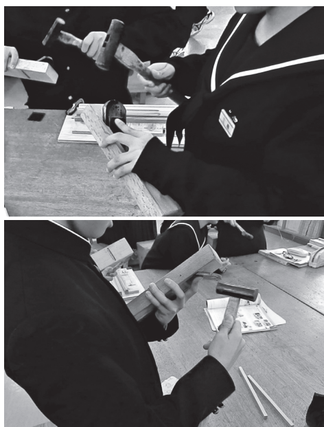
図 16 刃出し量を調整する様子
