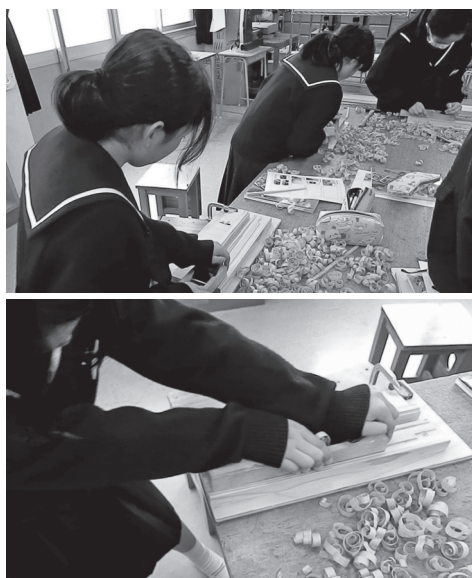
図 17 押しながら引いて鉋削りをする様子
