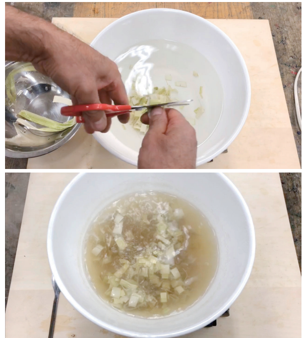
図5 白皮を裁断し、アルカリ溶液で煮る
