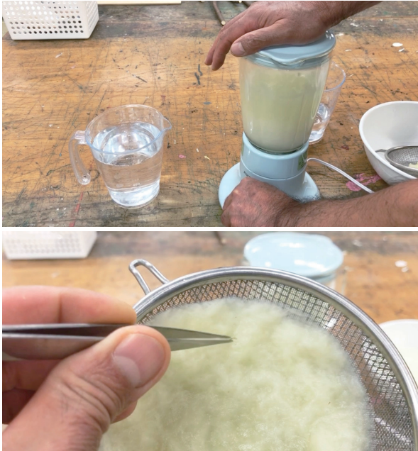
図7 ミキサーで繊維を打解したのち「ちりとり」をする
