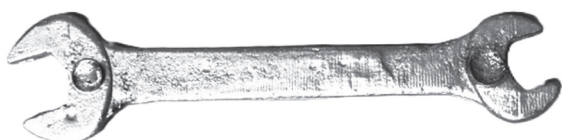
図 16 水平型の鑄型で試作した両口スパナ
