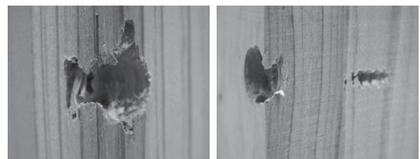
図6 ねじが外側に貫通した様子
