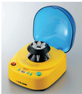
図3 比較的高速回転が可能だが安価なハイスピンミニ遠心機を活用
