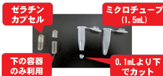
図7 ゼラチンカプセルのタンパク質分解酵素反応への利用
