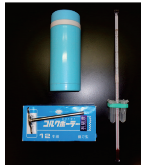
図6 マイクロチューブをセットした発泡スチロールと保温ポット、穴を開けるためのコルクボーラー
