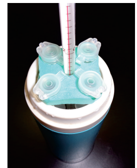
図6 マイクロチューブをセットした発泡スチロールと保温ポット、穴を開けるためのコルクボーラー
