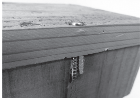
図8 キャップ木ねじ接合を失敗した練習材
