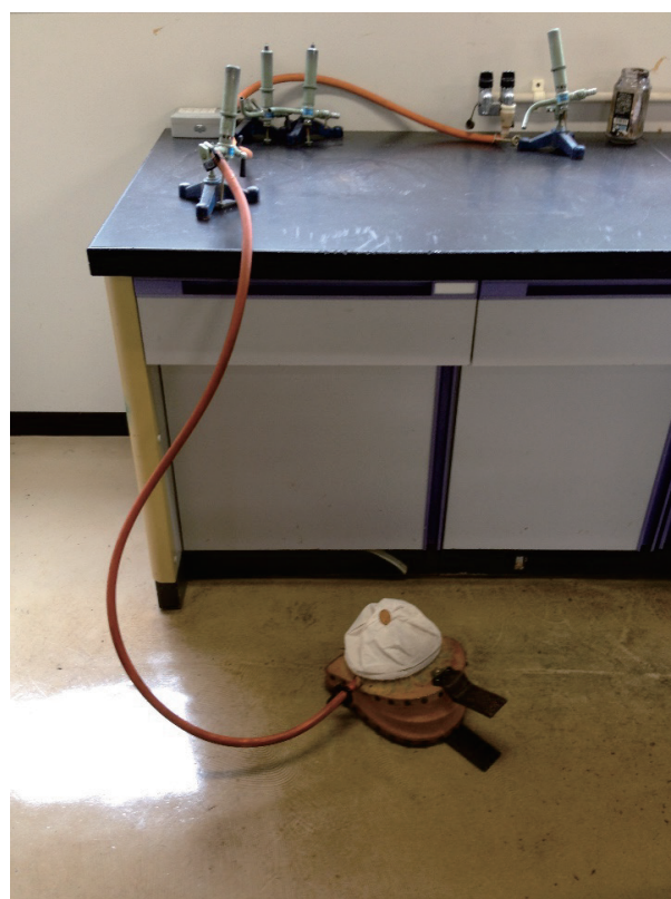
図6 ガラス細工に使用するガスバーナーとフイゴ
