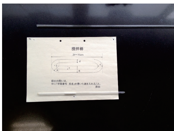
図5 中空軟質ガラス管とそれから作製した攪拌棒
