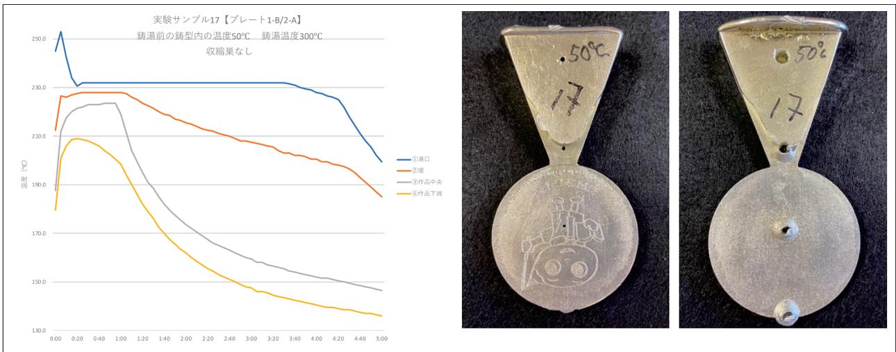
図10 実験サンプル 17 「温度変化のグラフと作品への影響」
