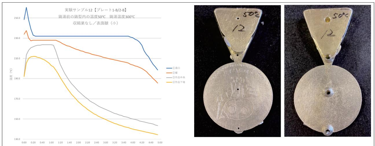
図 7 実験サンプル 12 「温度変化のグラフと作品への影響」
