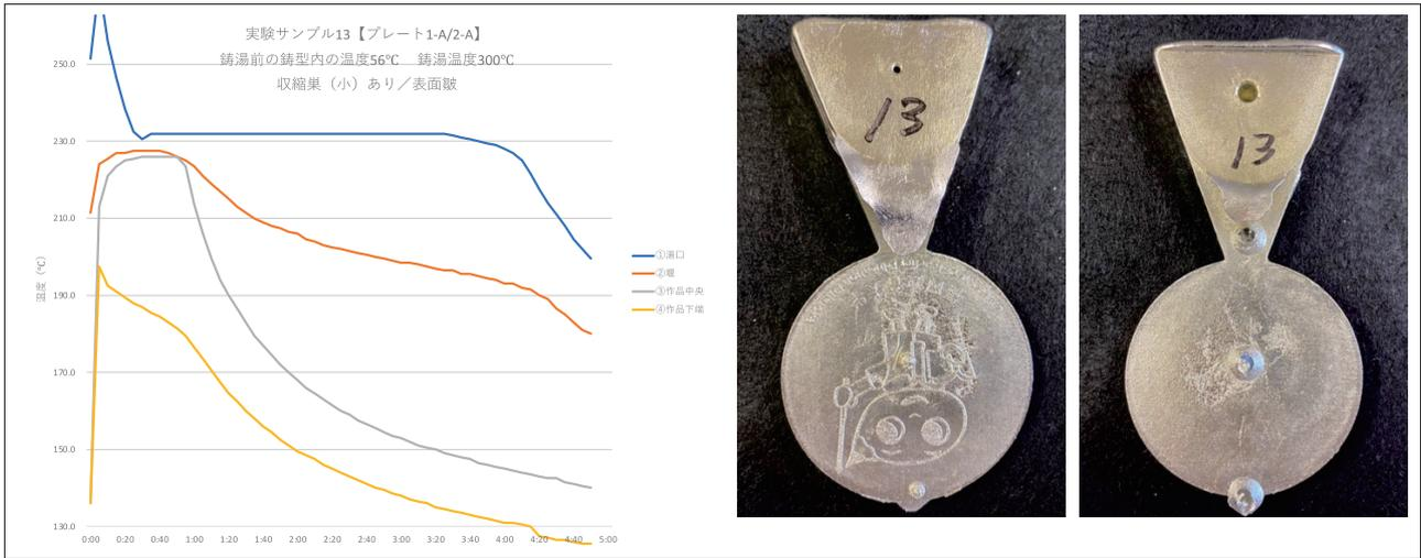
図8 実験サンプル 13 「温度変化のグラフと作品への影響」
