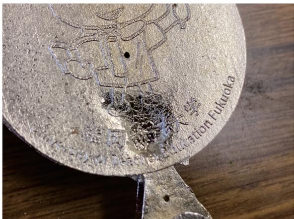
図2 メダルの凹み
