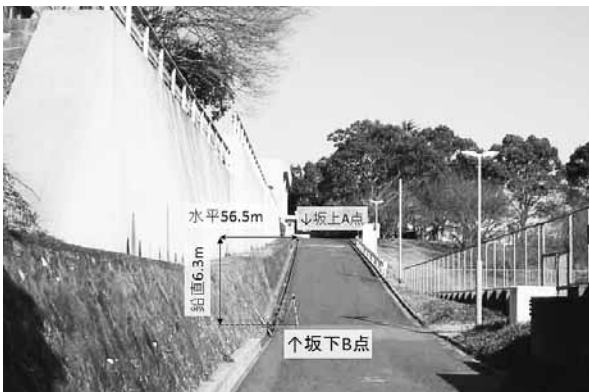
写真 2 移動速度と標高差の影響試験の状況
