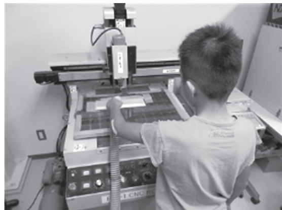
図6 CNC ルータを用いて加工している様子
