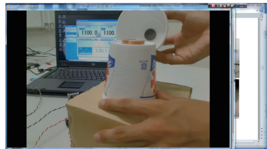
写真3 紙コップ、永久磁石(写真中央上に示す紙コップ底部内側の黒丸部)、コイル(手前の紙コップ底部外側)でDSを作製し、パソコン発振器とパワーアンプ(5W)で音を出す実験ビデオ。パソコンのヘッドホン端子からの信号をパワーアンプに接続し、DSから音を発生させる。
