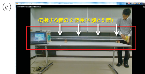
写真2 音の縦波を共鳴現象で視覚化する実験ビデオ。写真中の矢印は、音の「腹」の位置を示す。(a) 1波長共鳴現象、(b) 3/2波長共鳴現象、(c) 2波長共鳴現象
