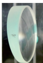
写真5 頂角 \theta=7.68^\circ のウェッジプリズム
